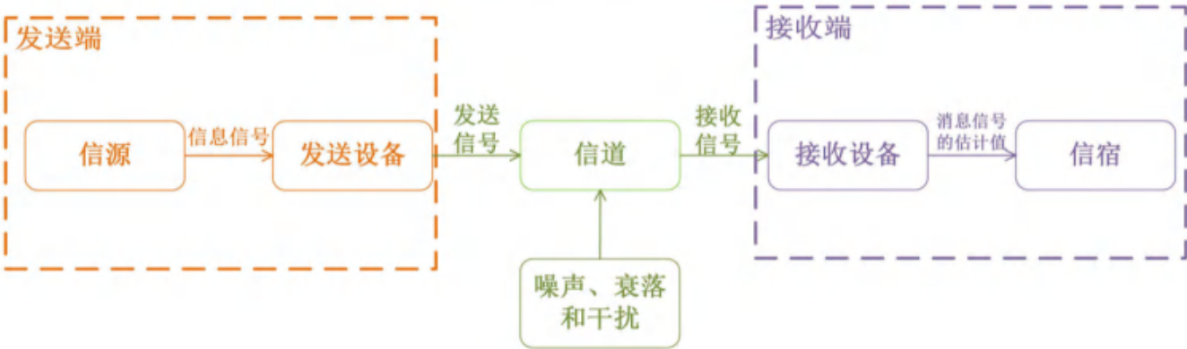
图 1.1.1 无线电通信系统
